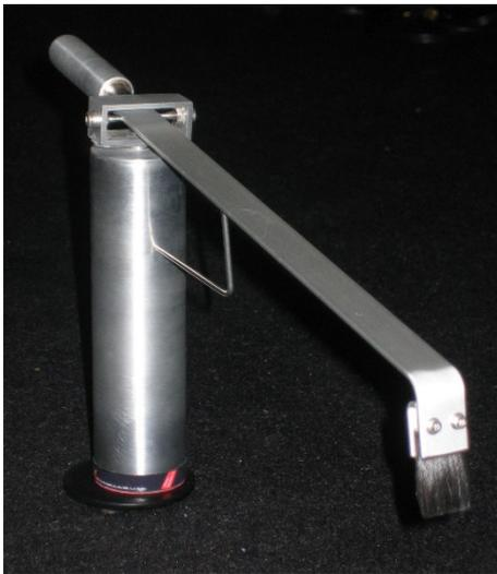
Eine weitere grundlegende Bauform ist das Rundrohr. Im Gegensatz zu den Rechteckvarianten ist der Drehpunkt hier mittig angeordnet, was eine geänderte Geographie der verbauten Magnete im Rohr mit sich brachte.
