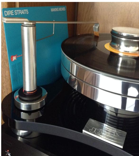
Als Sonderanfertigung für den ZET1 wird der Besenfuß auf einer Stahlrunde gesetzt, damit auch keinerlei Beschädigung des Laufwerks möglich wird. Zudem löst die Metallrunde das Problem der ggf. fehlenden magnetischen Eigenschaft am Aufstellort.
