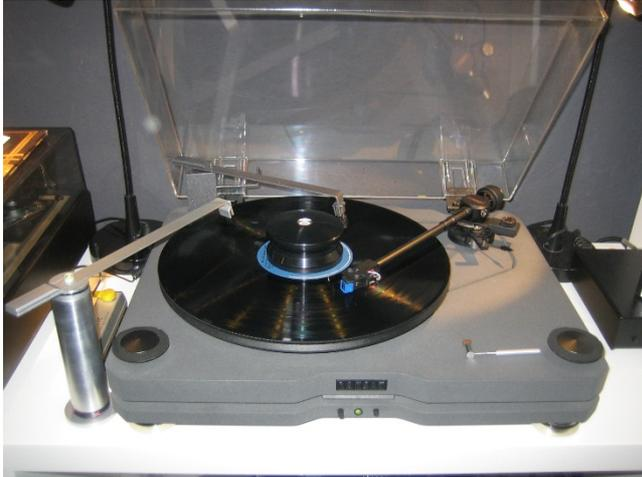
In dieser Abbildung ist das „Beiseitestellen“ des Mitlaufbesens mal an einem Roksan Radius zu sehen. Der lange Besenarm lässt eine großzügige Positionierung des Besenfußes zu. Beachtet werden muss eigentlich nur, dass die Bürste auf ihrem Weg zur Schallplatten Mitte auch wirklich auf die Mitte hin zu läuft. Nur extrem krasse Fehlpositionierungen führen zu einem Funktionsausfall.
